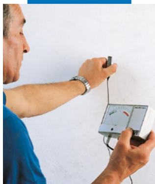
Проверка на влажността на гипсовата мазилка
